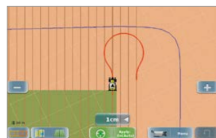
Dzięki AUTO TURN ciągnik automatycznie wykonuje nawroty.
