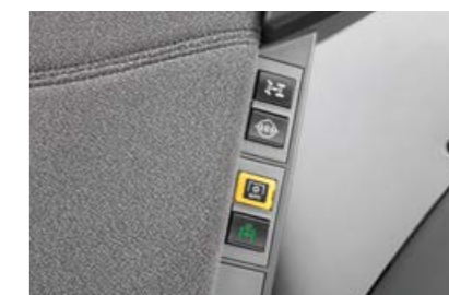
Aktywacja amortyzacji przedniej osi.
