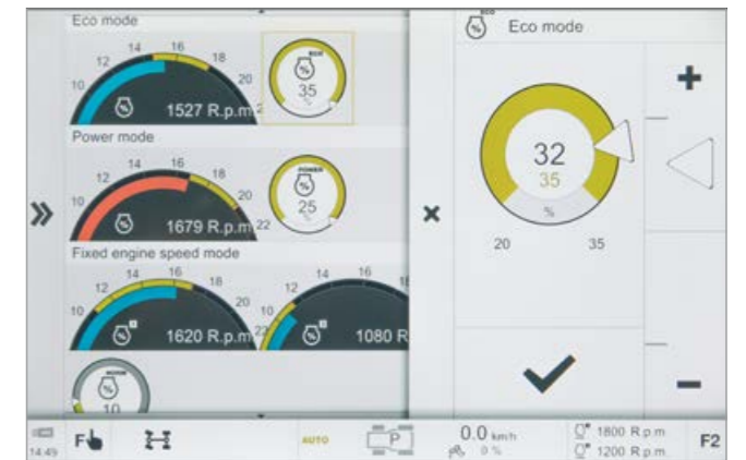
Ustawienie droop wartości „Eco” i „Power” oraz pamięci liczby obrotów silnika.
