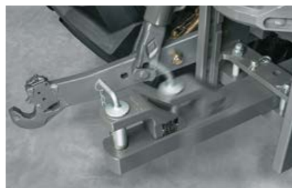
Warianty zaczepów polowych oferują wiele położeń. Pozycja wyciągnięta umożliwia lepszą zwrotność.
