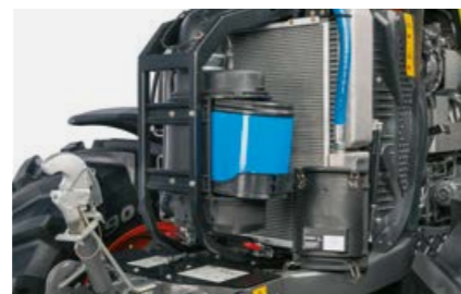
Filtr powietrza silnika umieszczony przed chłodnicą jest bardzo łatwo dostępny z poziomu ziemi.
