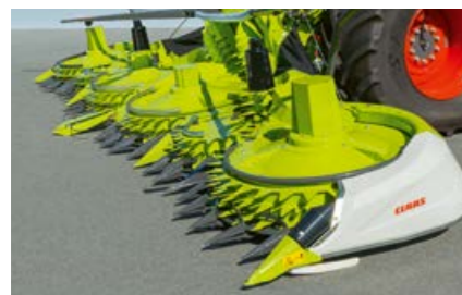
Bardzo płaska konstrukcja zapewnia niską wysokość ścierniska.
