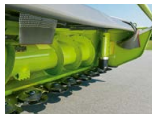
DIRECT DISC 600/500 ze ślimakiem wciągającym o dużej średnicy.
