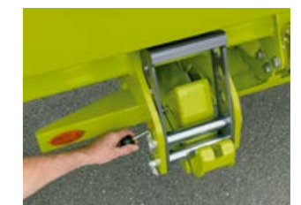
Po zaryglowaniu bezpieczna jazda po drodze z prędkością do 40 km/h.
