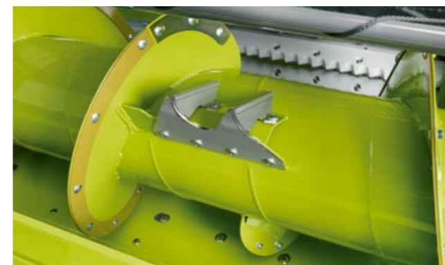
Ślimak wciągający o średnicy 600 mm dla wysokiej przepustowości
