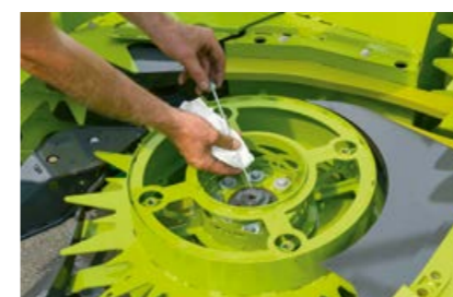
Bagnet pomiarowy do kontroli oleju.
