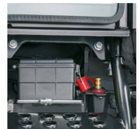
ELIOS 300 ułatwia codzienną pracę dzięki licznym inteligentnym rozwiązaniom, jak np. złącza prądu po prawej stronie kabiny.
