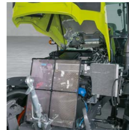
Chłodnicę można wysunąć, a jej sito wyjąć na potrzeby kontroli i czyszczenia.
