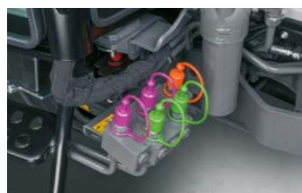
Z przodu dostępne są maks. cztery przyłącza hydrauliczne oraz jeden swobodny powrót.
