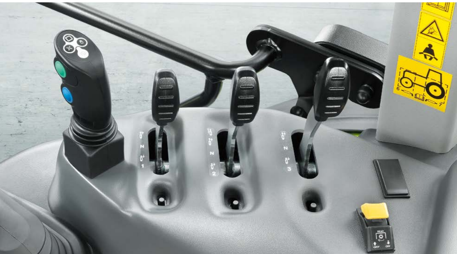
Maksymalną ilość przepływu mechanicznego zaworu hydraulicznego nr 3 można ograniczyć z kabiny jednym ruchem ręki.
