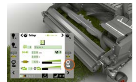
POWER FEEDING SYSTEM można rewersować łatwo z kabiny operatora.
